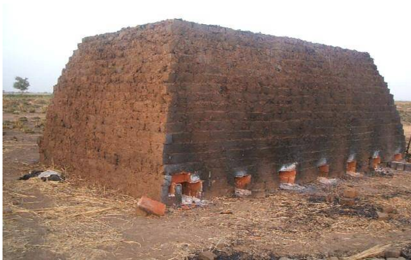
Photo.1 : Four artisanal pour la cuisson des briques
