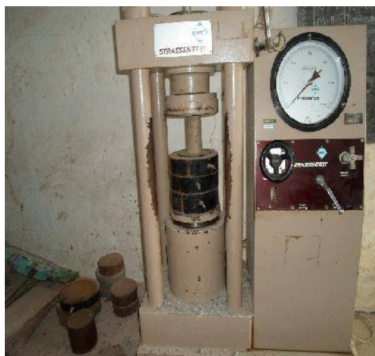
Photo.7 : Presse universelle pour les essais à la compression
