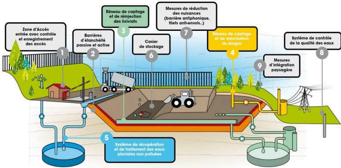
Figure 3 : Schéma de fonctionnement d'un CET (Source : syvadece.fr)
