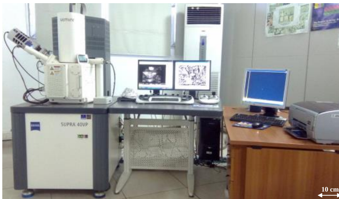
Figure 10 : MEB équipé d'un détecteur de rayons-X relié à une plateforme de microanalyseur (Caractéristiques : Grossissement : 12 X à 1 000 000 X Résolution : 2 nm Voltage variable : 0,1 kV à 30 kV)
