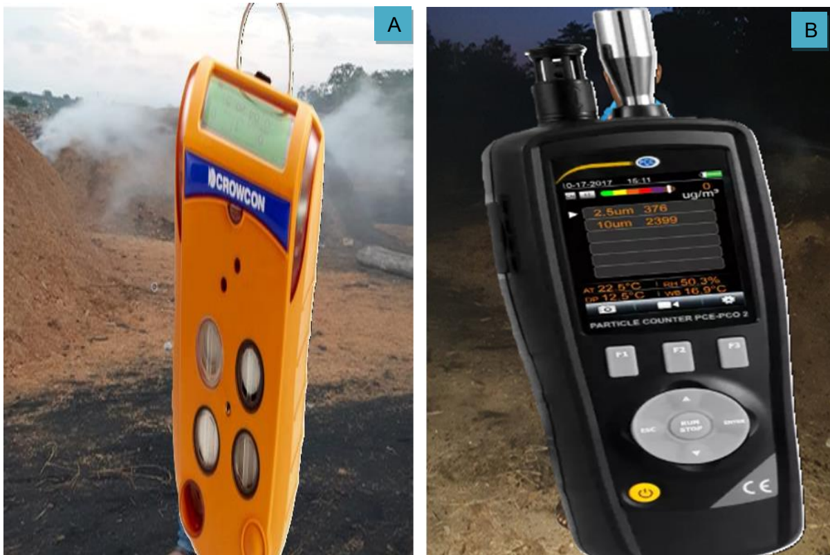
Figure 6 : Images illustrant les étapes de mesures des gaz de combustion et des particules dans l'air ambiant
