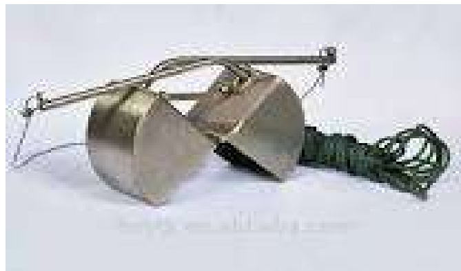
Figure 10 : Benne de type van veen d'une surface de 250 cm 2
