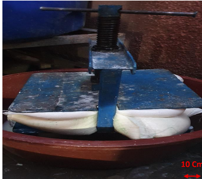
Figure 25 : Pressage de la pâte de manioc
