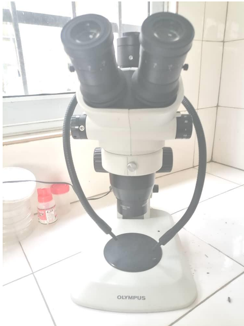
Figure 19: Loupe binoculaire utilisée pour l'identification des échantillons
