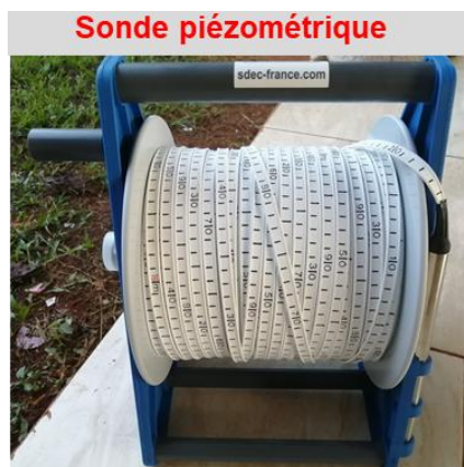
Figure 26 : Sonde piézométriques utilisée pour la mesure des profondeurs piézométriques
