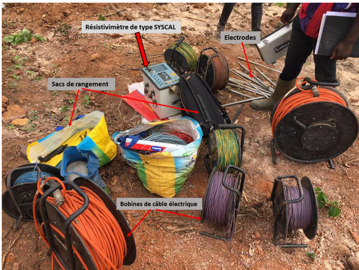
Figure 27 : Résistivimètre de type SYSCAL et accessoires
