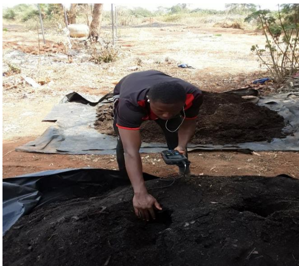
Figure 12: Aperçu d'une séance de mesure de la température, de l'humidité et du pH
