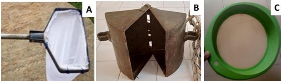
Figure 7 : Matériel d'échantillonnage des macroinvertébrés des lacs urbains de Yamoussoukro (Côte d'Ivoire) : A = Filet troubleau ; B = Benne Van Veen ; C = Tamis de 1 mm de vide maille
