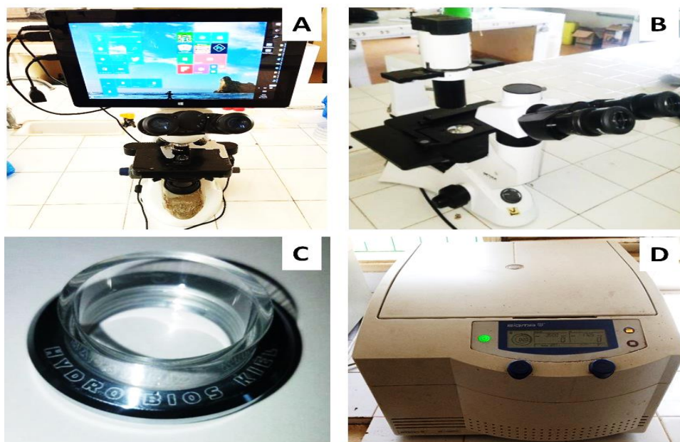
Figure 9 : Matériel d'observation, d'identification et de dénombrement du plancton A = Microscope optique ; B = Microscope inversé ; C = Cuve de sédimentation ; D = Centrifugeuse
