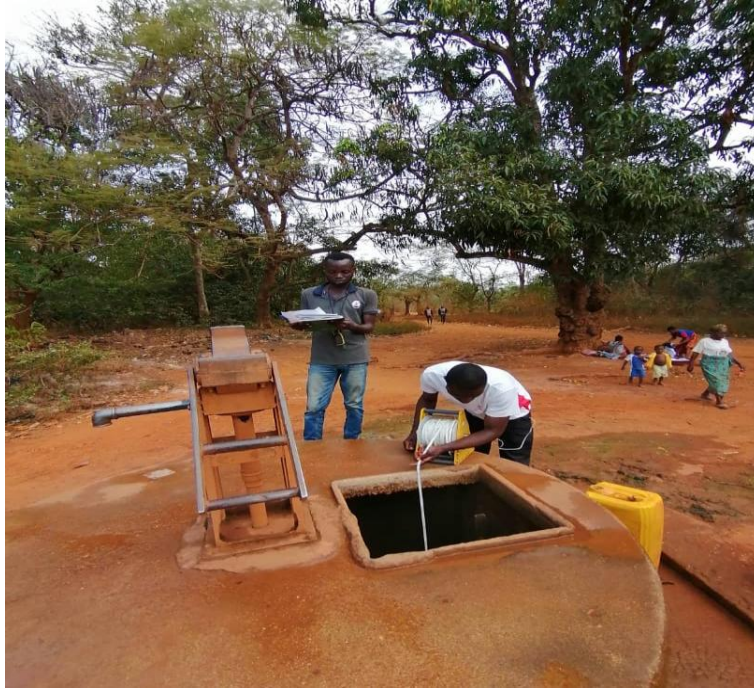
Figure 9: Prise de niveau d'eau dans un forage non fonctionnel à Amonkro
