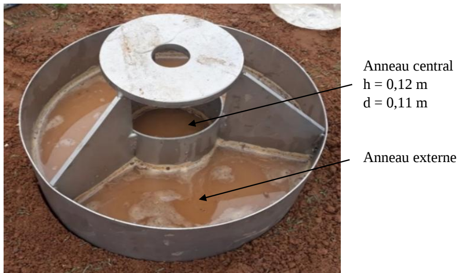
Figure 15 : Dispositif de mesure de la conductivité hydraulique de la couche superficielle
