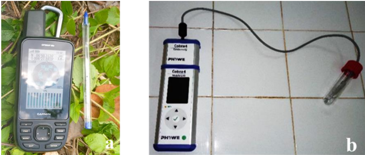
Figure 15 : Outils utilisés pour la caractérisation abiotique des milieux aquatiques à Daloa
