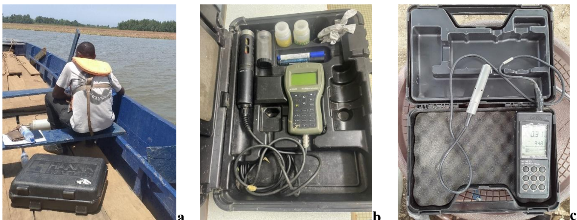
Figure 16 : Appareils de mesures in situ (Multi-paramètre de type HANNA )
