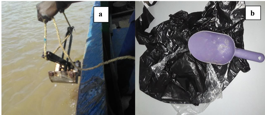
Figure 15 : Equipements de prélèvement de sédiment
