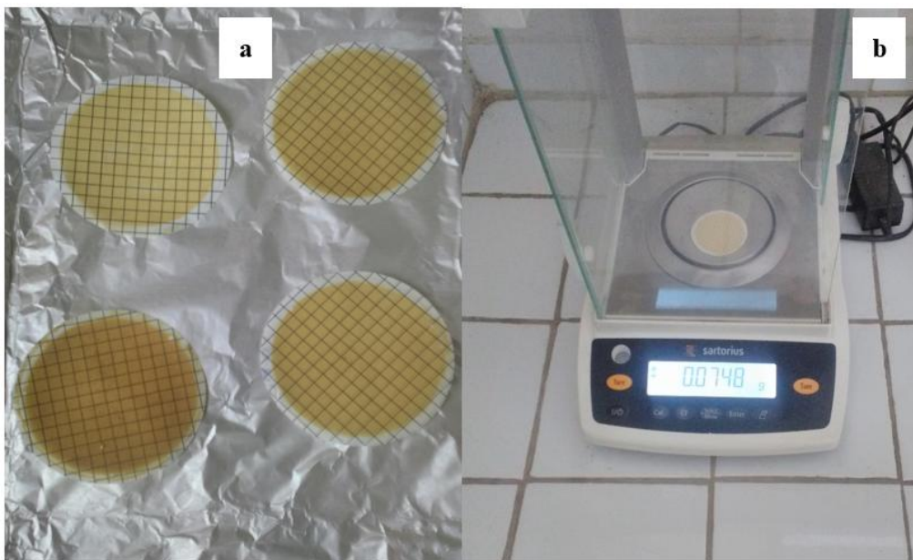
Figure 25 : Mesure de la masse des matières solide en suspension
