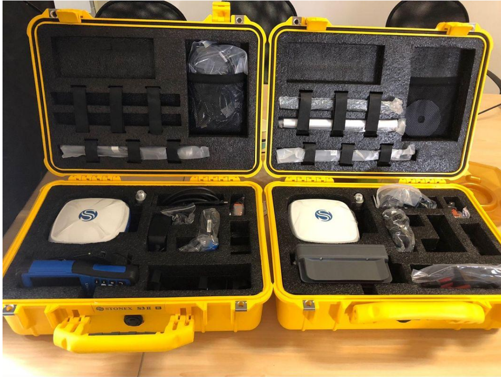
Figure 18 : Appareil de sondage topographique (STONEX S3i)
