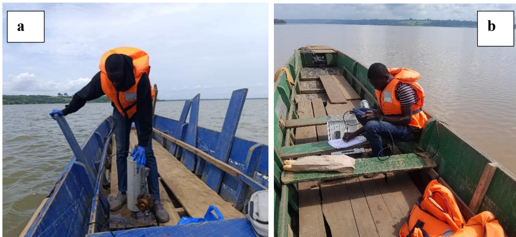
Figure 24 : Mesure in situ des paramètres physico-chimiques
