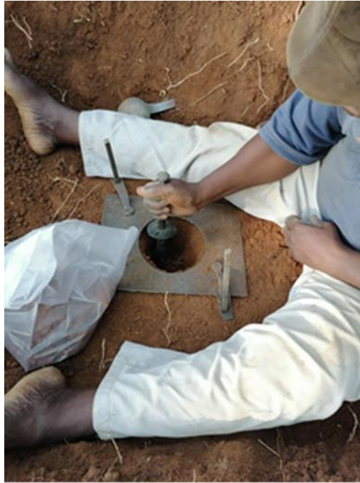
Figure 20 : Mesure in situ de la densité apparente par la méthode au sable marin
