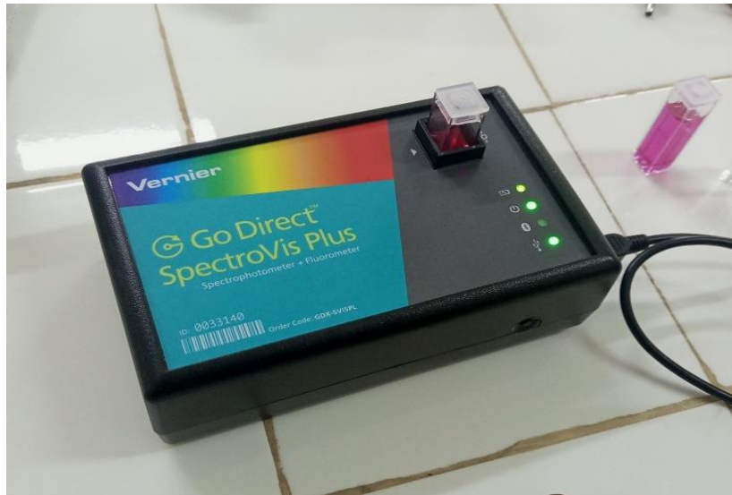
Figure 23 : Mesure de la densité optique du gel à l'aide d'un spectrophotomètre
