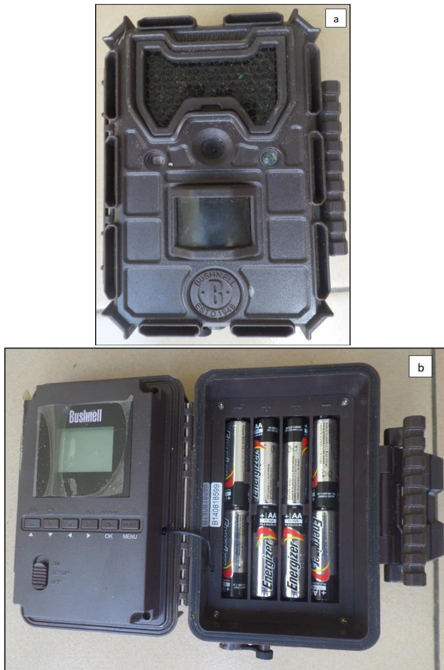
Figure 10 : Piège photographique Trophy Cam HD Essential E3
