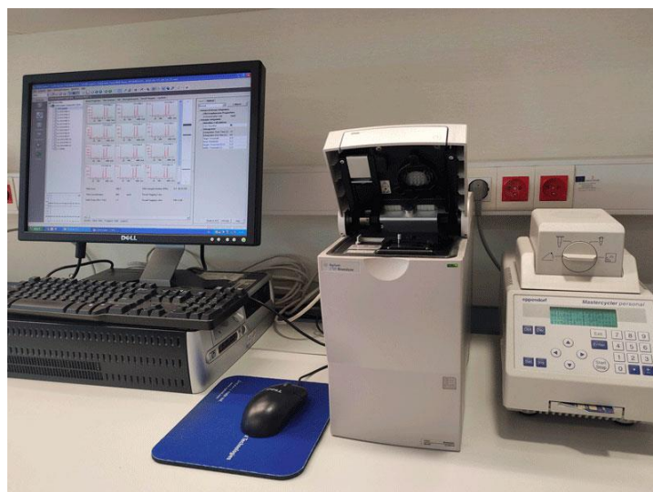
Figure 17 : Bioanalyzer Agilent 2100 permettant de visualiser les échantillons d'ARN total.
