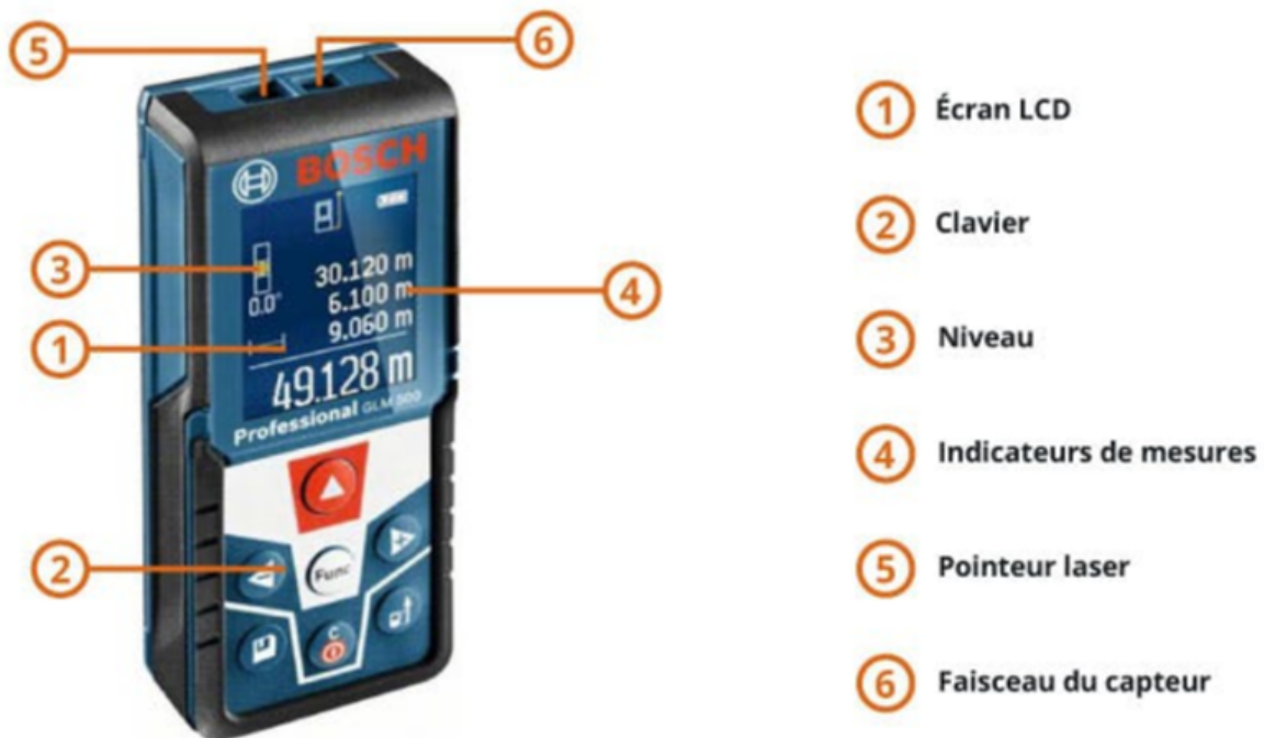
FIGURE 2.2 – Le Télémètre LASER de distances [28]
