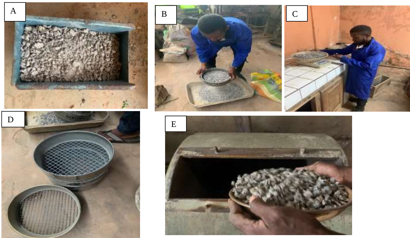
Figure 15 : Les étapes de l'essai mécaniques des échantillons au laboratoire ; A- Concassage ; B-Tamisage ; C-pesage ; D-colone des tamis de classe 6,3/10 et 10/14 ; E-introduction de l'échantillon de la machine los Angeles.
