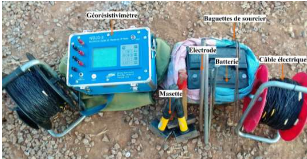
Figure 10 : Equipement de mesure géoélectrique
