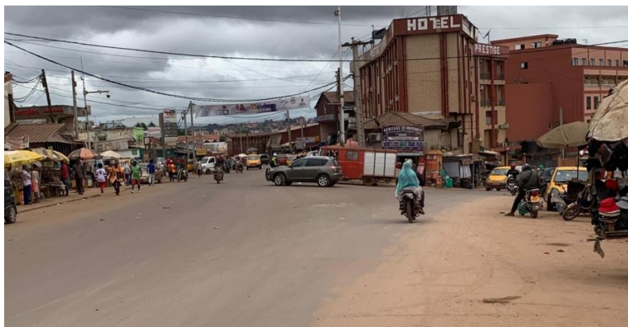
Photo 6: Absence de signalisation verticale et horizontale (Carrefour Biyem Assi)
