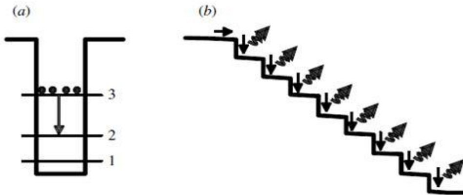
Figure I-10 : Schéma des dispositifs qui caractérisent le fonctionnement des QCLs. (a) Unipolarité, transition optique entre sous bandes. (b) Cascade : beaucoup de photons par électron.
