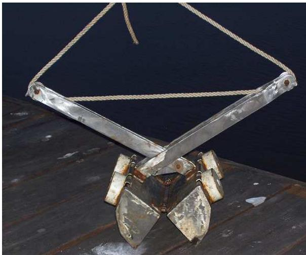
**Photo 8 :** Benne Van Veen utilisée pour les prélèvements de sédiments de l'estuaire du fleuve Comoé
