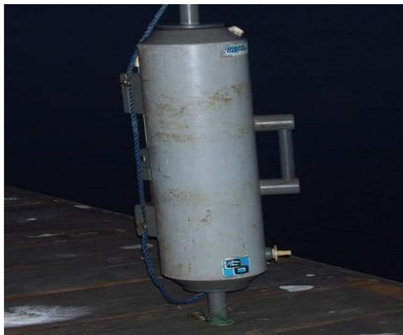
**Photo 7 :** Bouteille hydrologique utilisée pour les prélèvements d'eau du fleuve Comoé
