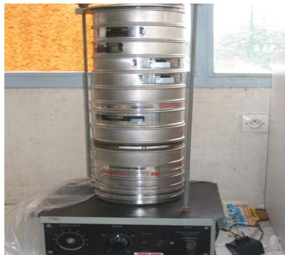
**Photo 9 :** Colonne de tamis montée sur la tamiseuse
