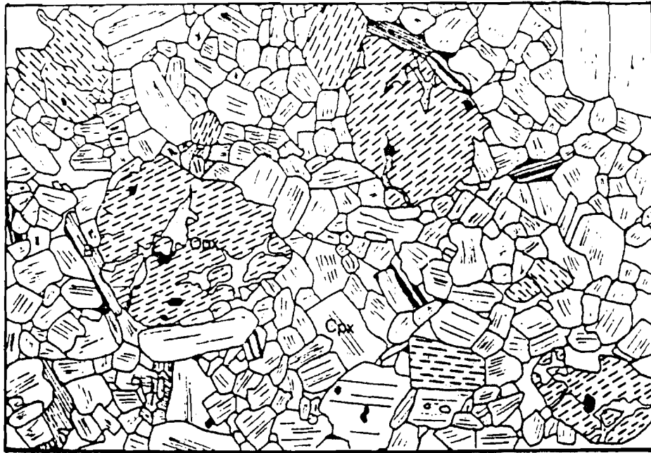
Fig. 24 - Texture à tendance cumulative des gabbros riches en pyroxènes de la région de Tonkouto. L'Opx et le Cpx sont en phases cumulus tandis que le plagioclase (Pl) et la biotite (B) sont en phases intercumulus.
