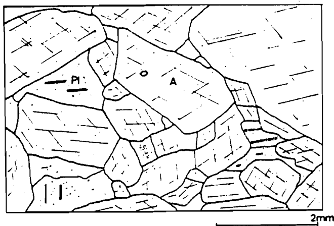
Fig. 30 - Texture des gabbros à mégacristaux d'amphibole. Les plagioclases (Pl) sont xénomorphes, alors que l'amphibole (A) qui est la principale phase ferromagnésienne, est automorphe.
