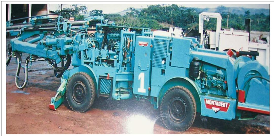
Photo 39 : Marteau piqueur de marque Montalbert utilisé dans l'abattage de la roche au fond de la mine (Photo, COMUF)
