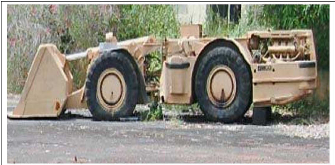
Photo 40 : Pelleteuse mécanique de forme allongée adaptée au travail au fond de la mine (JPM, mai 2005)
