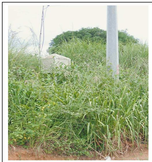
Photo 60: Appareil dosimètre alpha de site mesurant la pollution de l'air à l'entrée de la cité Rénovation (Cliché : JPK, Avril 2000).
