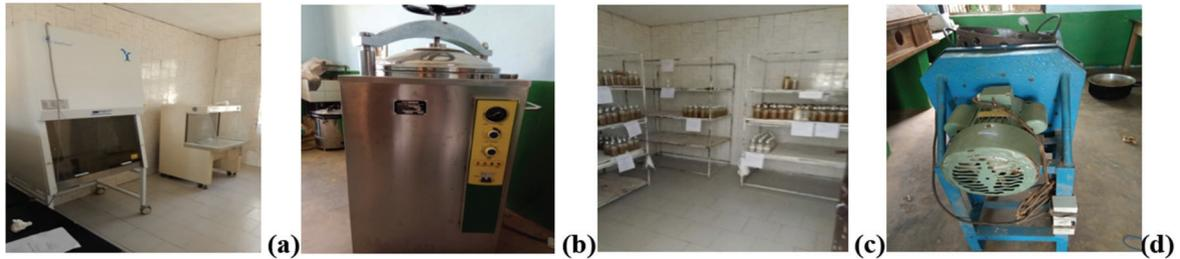
Figure 1 : (a) Flux laminaires ; (b) Autoclave ; (c) Étagères salle blanche ; (d) Concasseur électrique
