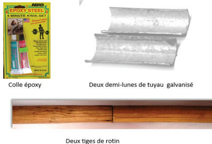
Photo 1 : Eléments entrant dans la constitution de la section mixte métal-rotin
