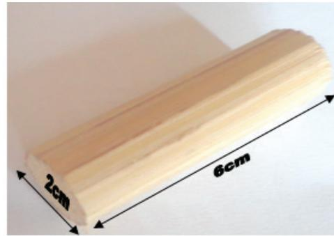
**Photo 3 : Eprouvette de rotin normalisée**
