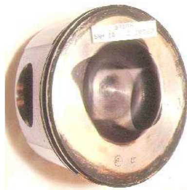
Fig. B2 : Piston modifié après 500 heures à huile de colza (Photo CIRAD)
