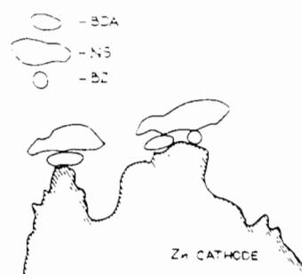
Fig. I.3 : Représentation schématique de l'adsorption des espèces associées[28]
