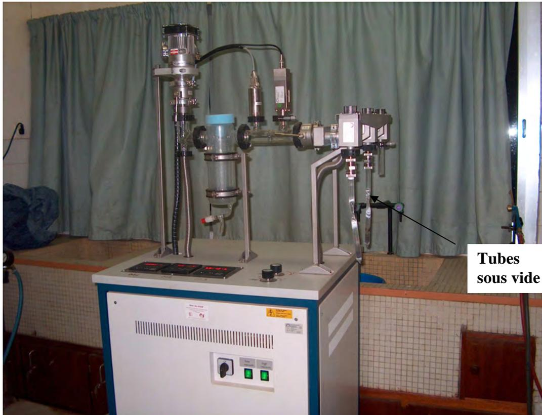
**Photo 2.1 : Photo de la pompe à vide secondaire mettant en évidence des tubes sous vide**
