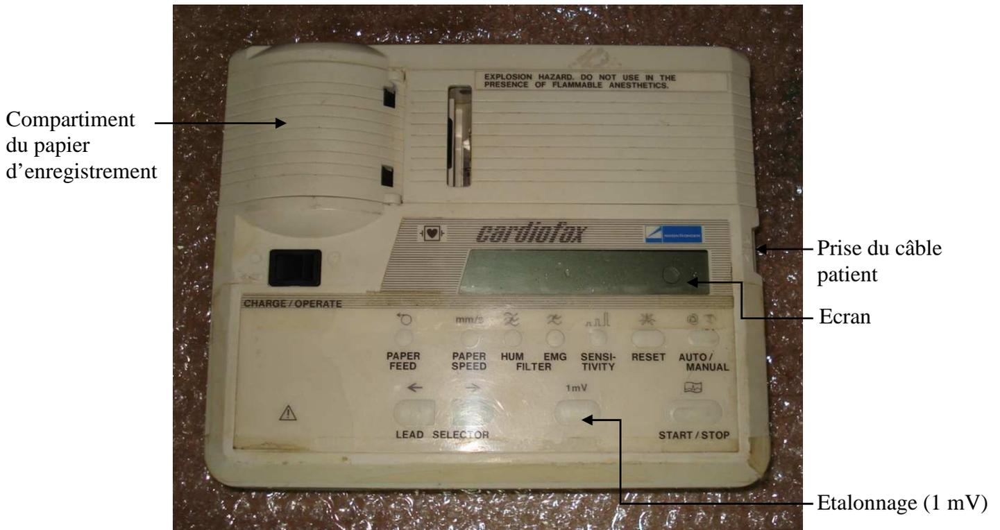
**Figure 27 : photographie du cardiographe utilisé pour l'enregistrement de l'électrocardiogramme (ECG)**
