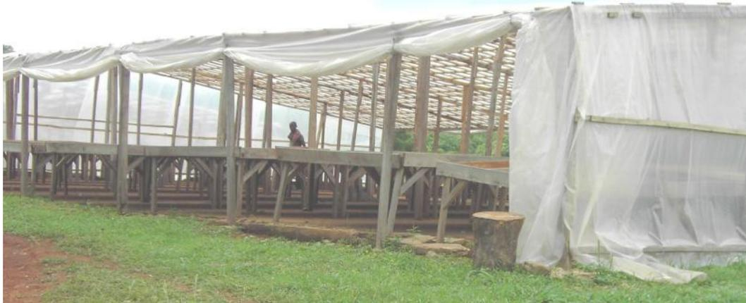
**Figure I.10 : Séchoir tente solaire à Tombokro (Assidjo *et al.*, 2008)**
