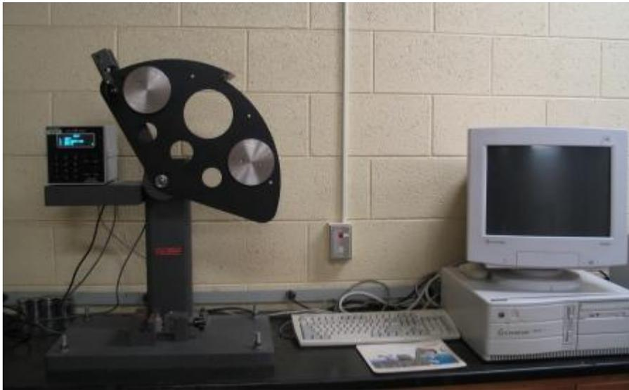
**Figure 2.25** : Machine d'essai de choc pendulaire
