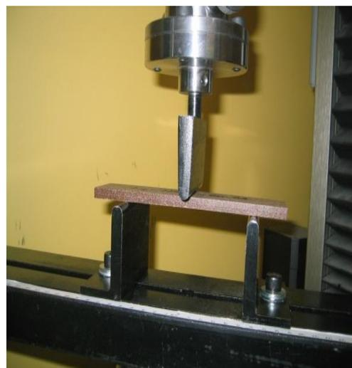
Figure 2.24: Test de flexion statique à trois points
