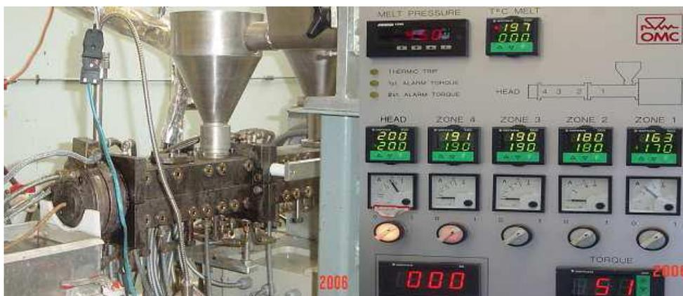
**Figure 2.8.** Extrudeuse bi-vis avec les différentes zones d'extrusion et de trémies d'alimentation.
