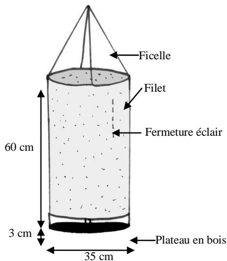
(a) Schéma descriptif d'un piège à charaxes
