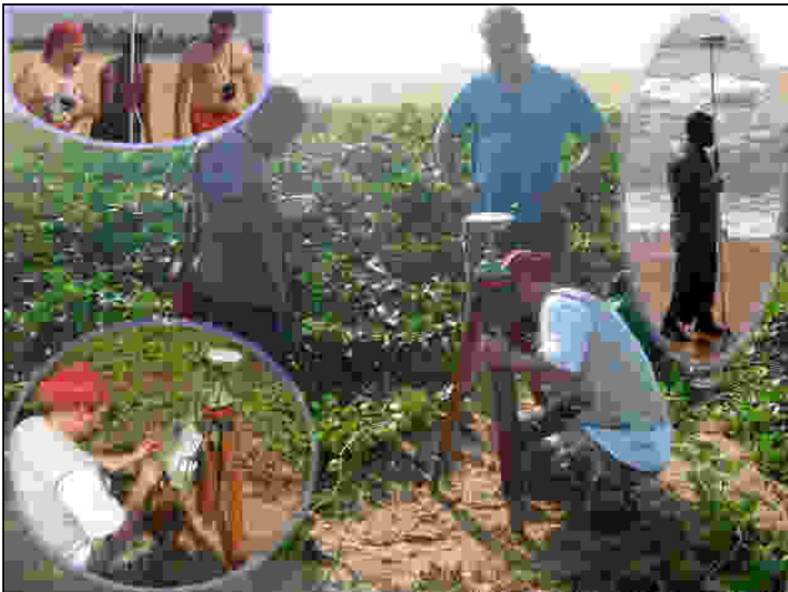
Photo 6.- Quelques images de la mission du 03/ au 13/12/2010 montrant les différentes composantes du DGPS utilisé pour les mesures topographiques (clichés LAIBI Raoul)
