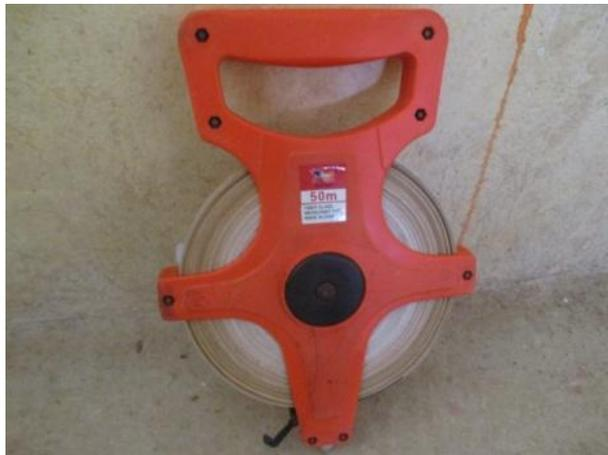
**Figure 14:** Photo d'un décamètre long de 50m.
