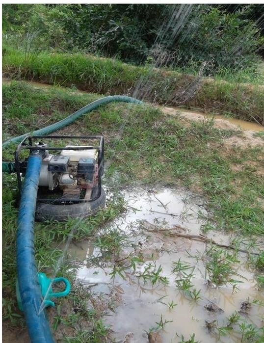
**Figure 7 : Mauvais état des tuyaux d'arrosage entraînant une perte d'eau**
