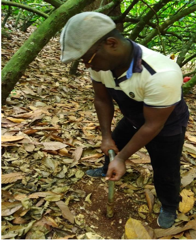
A : Prélèvement à la Tarière
