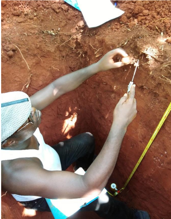
C : Enlèvement d'une motte de terre avec un couteau de pedologie
