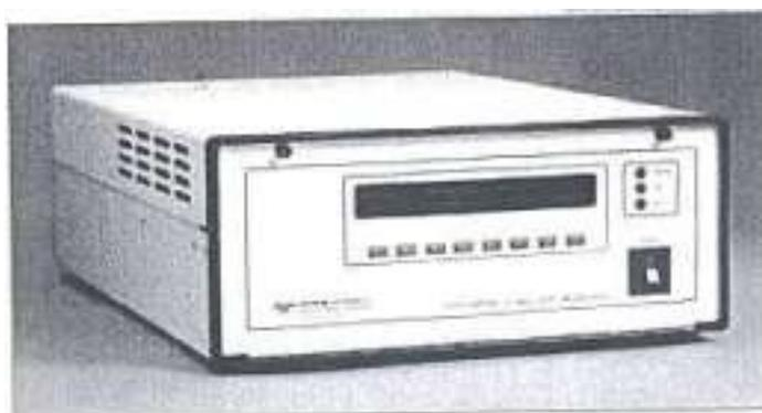
Le système d'acquisition interne permet l'enregistrement de multiples paramètres dont les concentrations moyennes et instantanées, les valeurs de calibration et des paramètres fonctionnels telles que pressions et débits. Jusqu'à 999,999 données sont stockées et sont facilement accessibles via le port sériel RS13-2, la connexion Ediniel (en option) ou la face avant, ce qui permet à l'utilisateur d'effectuer un diagnostic en détectant les tendances des paramètres.
