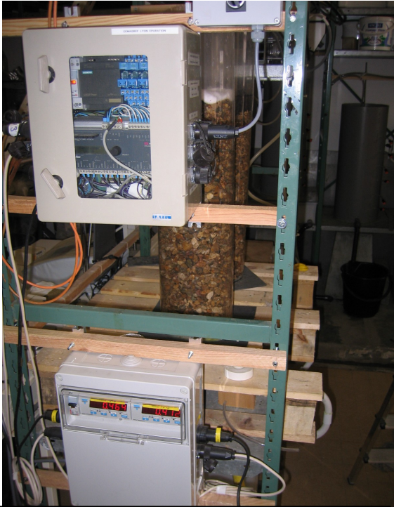
Enregistreur des vitesses de ressuyage et d'infiltration
