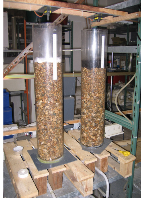
Colonnes d'essai d'infiltration-percolation
