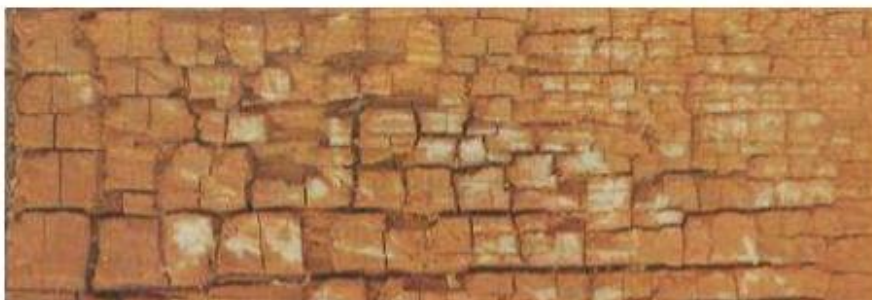
Figure 21 : Pourriture cubique causée par Anthrodia sp. (Fouquet, 2003).
