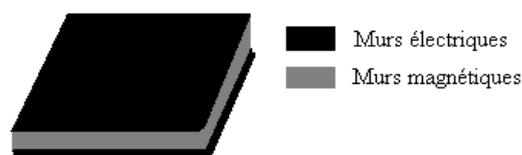
Fig. 1.13: Modèle de la cavité résonnante de l'antenne
