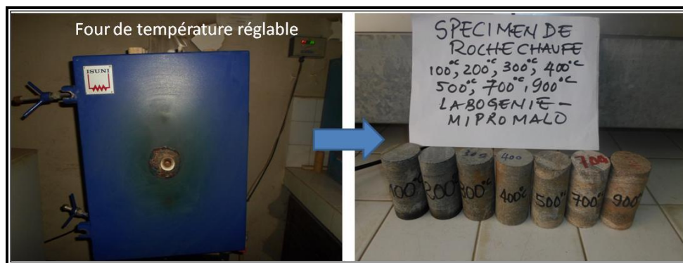
Figure 2.6 : Dispositif de traitement thermique des spécimens de roches.
