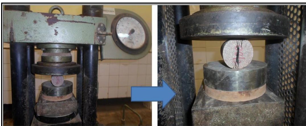
Figure 2.8 : Essai de traction indirecte sur l'éprouvette de roche
