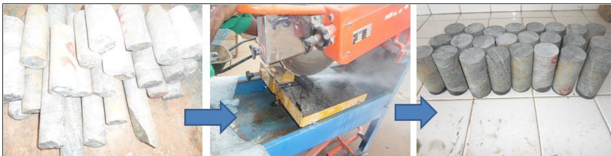
Figure 2.5 : Schéma illustrant les différentes étapes de la préparation des échantillons.
