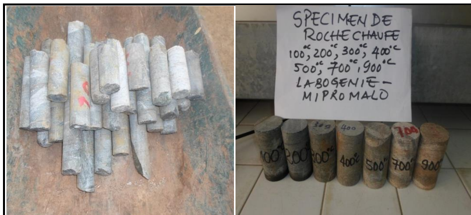
Figure 3.32 : Préparation et traitement thermique des échantillons de Gneiss prélevé à différentes températures.
