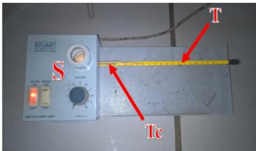
Figure 6 : Dispositif de prise du point de fusion.
