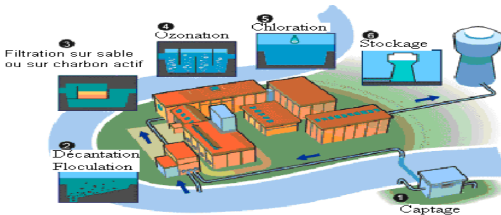
Figure 17 : Station de potabilisation (Source : http://www.environnement.gouv.fr )
