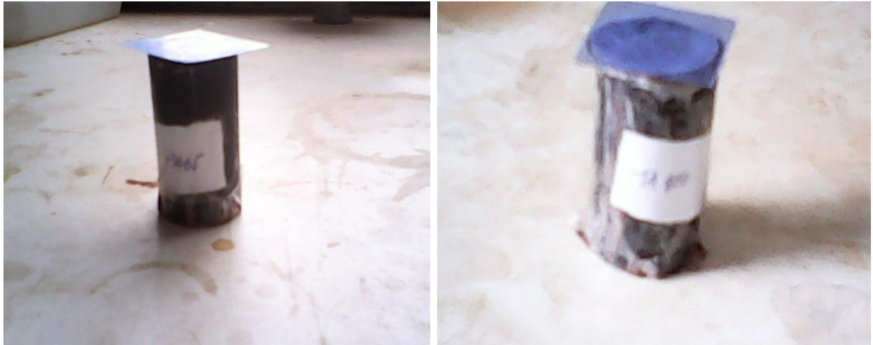
Figure 10: Coulage des liants dans des moules cylindriques en PVC
