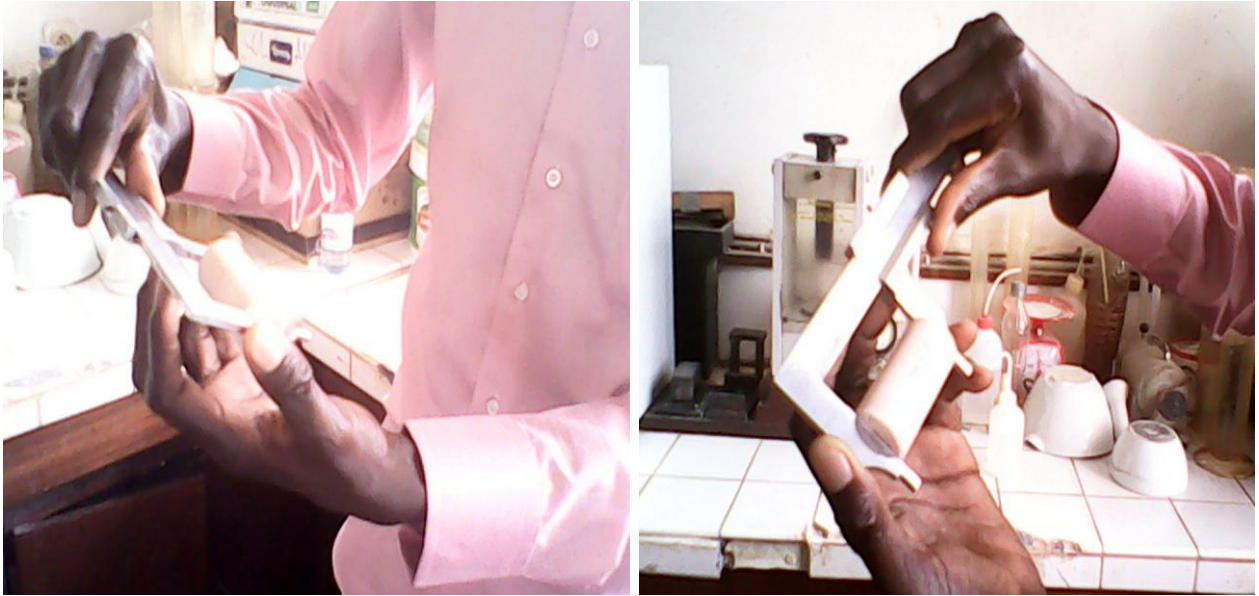
Figure 14 : Illustration de la mesure des longueurs d'éprouvettes pour le calcul du retrait linéaire. (Photo Ngally)
