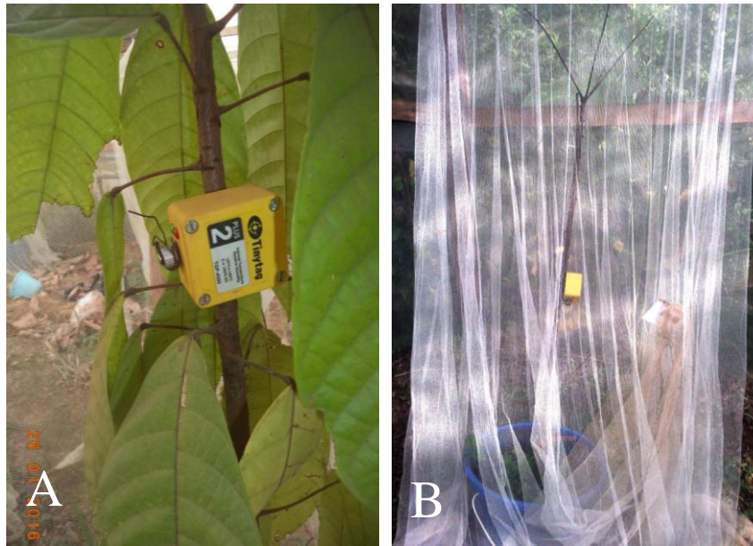
Figure 11 : Capteur thermohygrométrique (A : Sur un plan au milieu de la serre et sous feuillage; B: sur le tronc d'un plant mort dans un coin de la serre)
