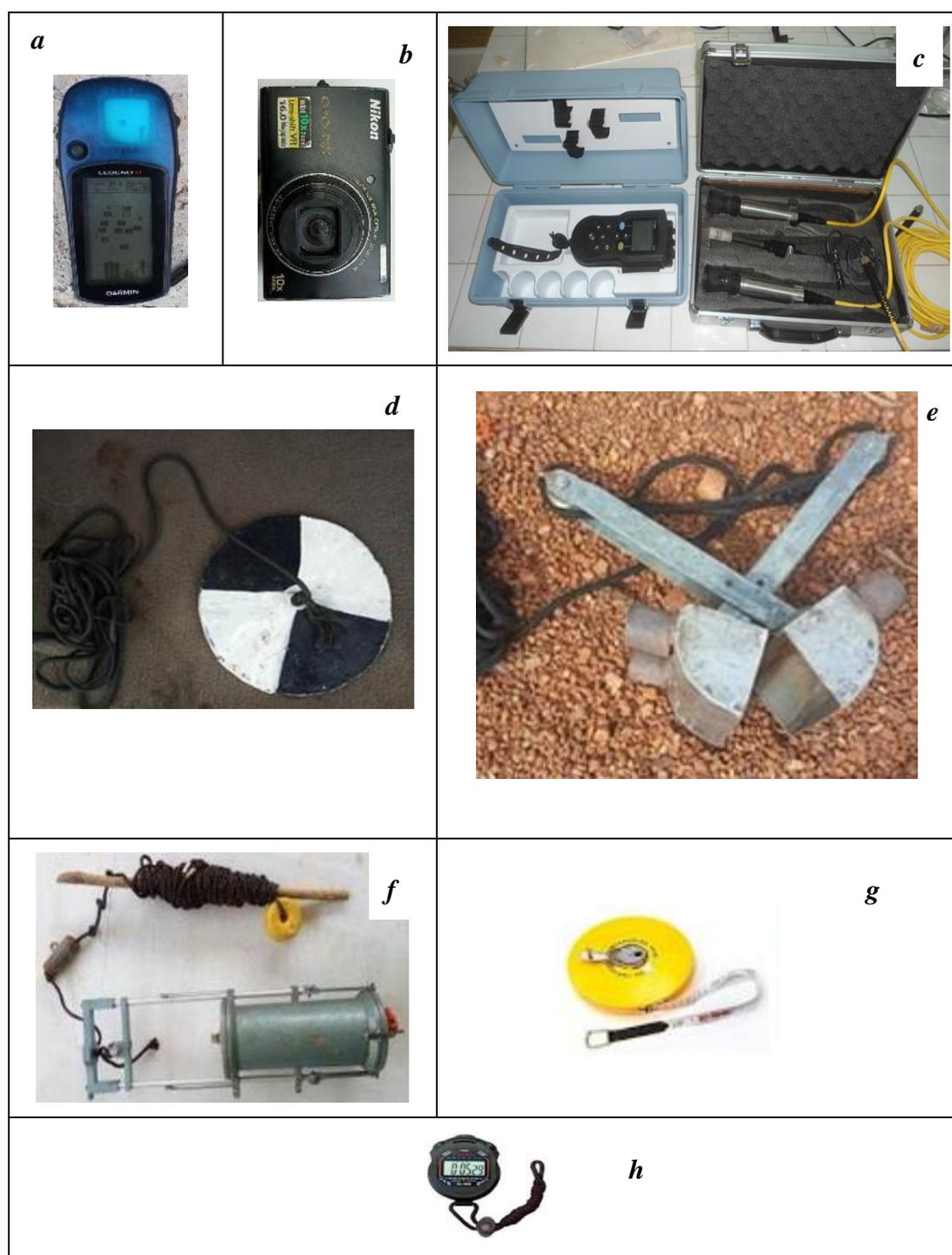
**Figure 5 :** Appareillage utilisé pour les mesures et prélèvements au cours de cette étude sur le fleuve Cavally: *a-* GPS, *b-* appareil photo, *c-* multiparamètre, *d-* disque de Secchi, *e-* benne Van Veen, *f-* bouteille hydrologique ; *g-* décimètre, *h-* Chronomètre..
