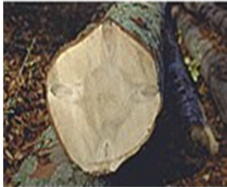
FIGURE 1.7 – Coupe transversale de sapin [1](photo CTBA)
