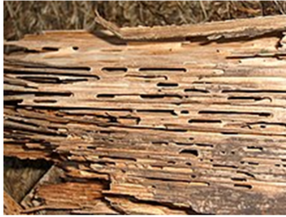
Figure 1.12 – Des fourmis ( Camponotus ), en symbiose avec un champignon, ont consommé les parties tendres des cernes du bois.
