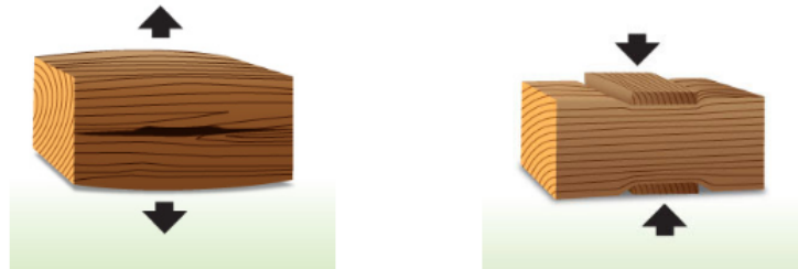
Figure 1.7 – Traction et compression perpendiculaire aux fibres
