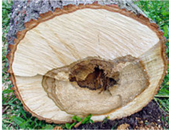
Figure 1.11 – Altération physique et colorée due à un champignon et des bactéries décomposant le bois par le coeur.
