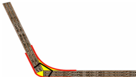
Figure 2.13 – Coupe des coutures et recouvrement du joint
