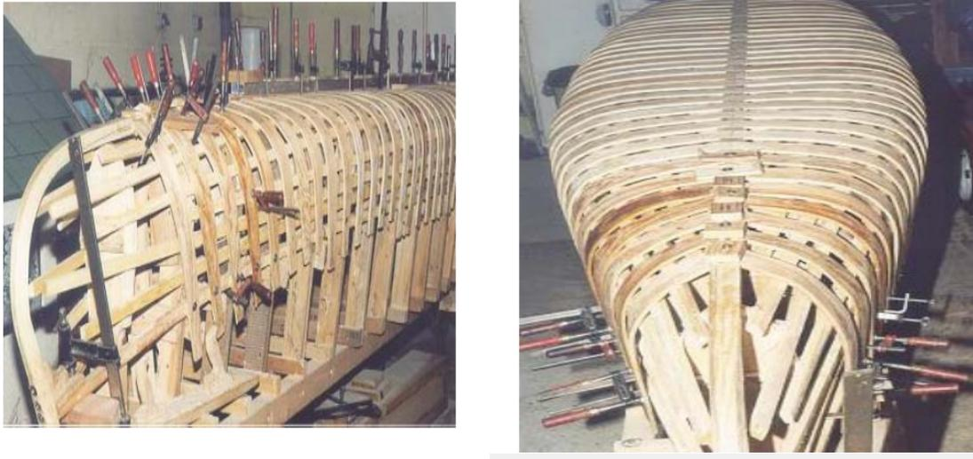
FIGURE 3.2 – Deuxième phase : Mise en place des couples
