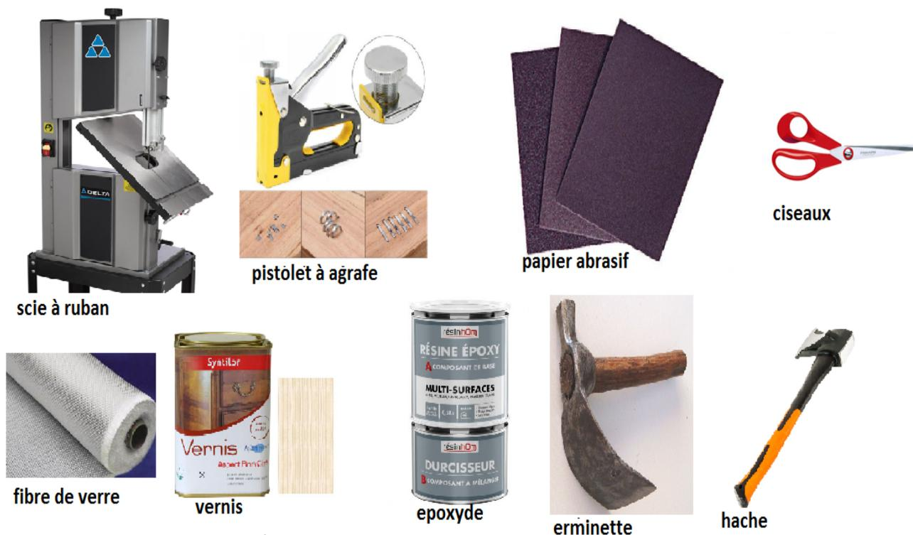
FIGURE 2.4 – Autres matériels utilisés pour la construction d'un canoë en bois latté
