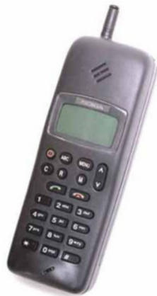
FIGURE 1.17 – Le Nokia 1011, le premier téléphone GSM produit en masse. Haut de 19,5 cm, il pèse 476 grammes.
